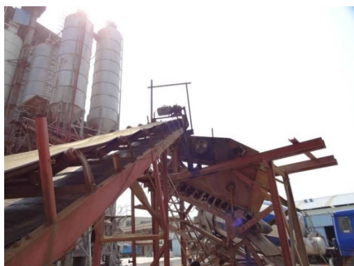
图 1.3-1 与混凝土并线生产(添加振动筛)
